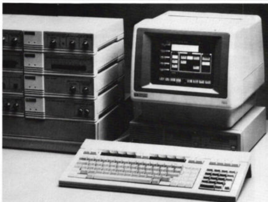
Afb. 1. Onder de benaming 'PC-instrumentensysteem' heeft Hewlett-Packard een geautomatiseerd test- en meetsysteem geïntroduceerd, dat gebruikt kan worden in diverse vakgebieden. Dit op een personal computer gebaseerde systeem bevat tot acht veelgebruikte meetinstrumenten, die modulair en stapelbaar zijn uitgevoerd. Bestuurd door systeem- en applicatie-programmatuur, kunnen deze modules samenwerken met het HP-tipscherm en de IBM-PC.
