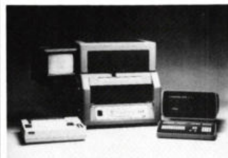
Systeem voor automatische laagdiktemeting Fischerscope X-ray 1500.
