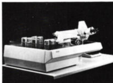
Inspectiestation voor 6-inch wafers van Zeiss.
